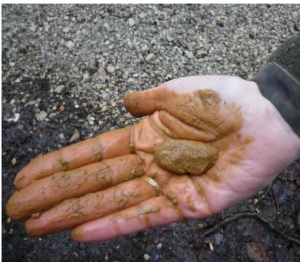
Abbildung 1 Boden im feuchten Zustand für die Fingerprobe
