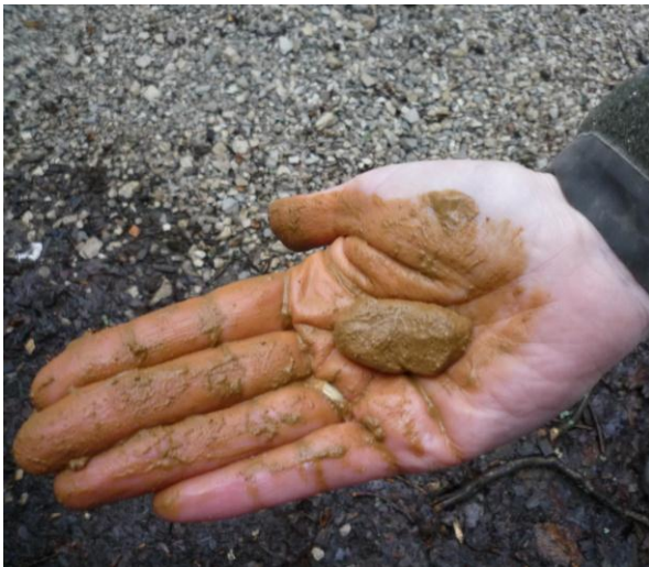
Abbildung 1 Boden im feuchten Zustand für die Fingerprobe
